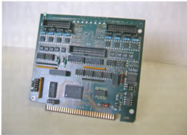
Рис. 2 Унифицированный модуль восьмиканального программи- руемого АЦП с параллельным преобразованием фирмы Fastwell, Россия
