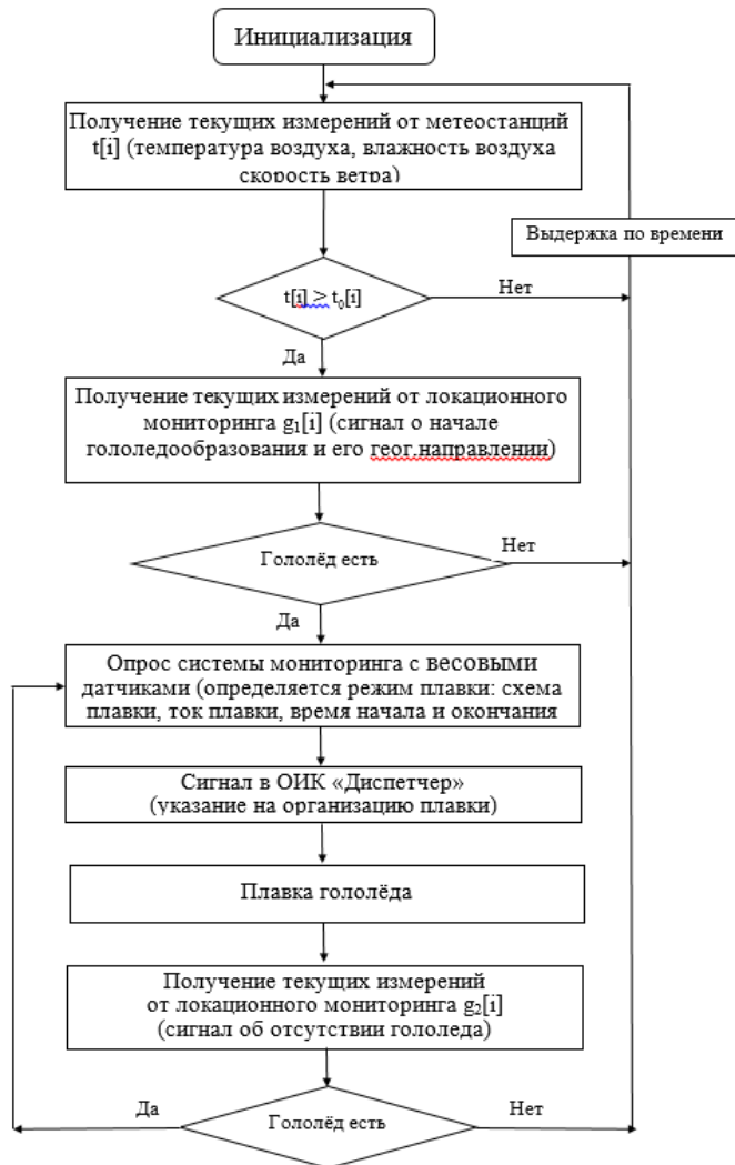
Рис. 2. Блок-схема алгоритма работы комплексной системы мониторинга
