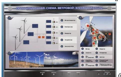
Рис. 3. Учебно-лабораторные стенды по изучению возобновляемой энергии: а – солнечная электростанция; б – ветряная электростанция
