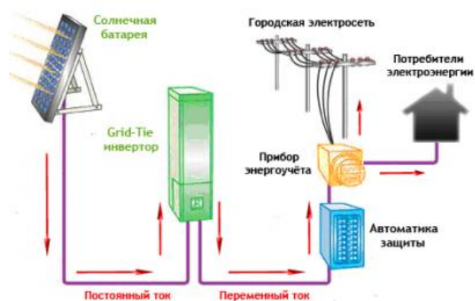
Рис. 4. Структурная схема типичой On-Grid ФЭС
