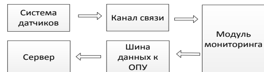
Рис. 3. Типовая архитектура системы мониторинга
