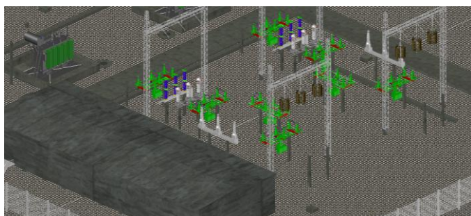
Рис. 3. CAD-модель платформы подстанции 110 кВ, созданная в программном комплексе Autodesk AutoCAD (общий вид)
