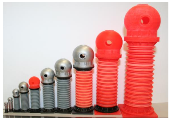
Рис. 2. Линейная прогрессия трансформаторов тока ТРГ-110 кВ в различных масштабах, напечатанная на 3D-принтере StarLight
