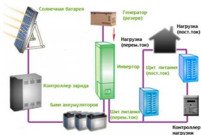
Рис. 2. Структурная схема автономной ФЭС
