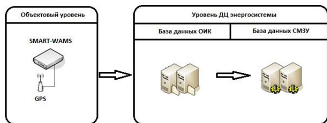
Структурная схема поступления данных от Smart-WAMS в диспетчерский центр энергосистемы
