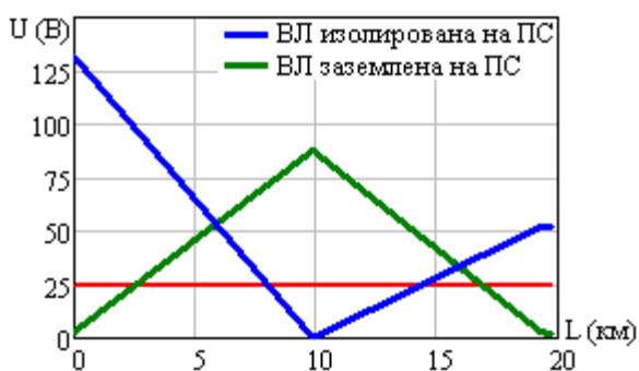
Рис. 4. Распределение наведенного напряжения на ВЛ в момент прохождения ЭПС напротив места ремонта – середины линии
