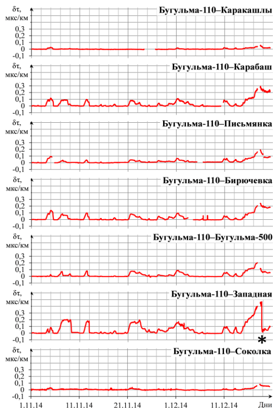
Рис. 4. Экран интерфейса оператора, на котором демонстрируются изменения удельного запаздывания \delta t отраженных локационных сигналов при образовании гололедных отложений на контролируемых линиях подстанции «Бугульма-110» [1.11 – 22.12.2014]
