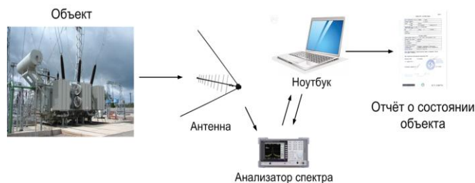
Рис. 1. Функциональная схема процесса регистрации и обработки информации методом электромагнитного контроля
