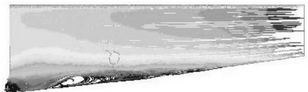
Рис. 5. Отрыв поток от периферийного обвода, возникновение кольцевого вращающегося вихря
