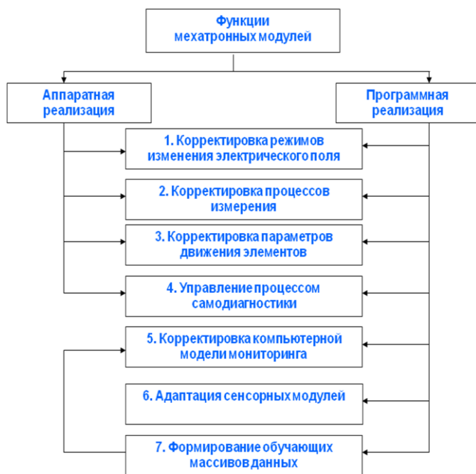
Рис. 2. Структура и взаимосвязи функций элементов мехатронного модуля
