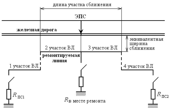
Рис. 1. Упрощенная схема сближения отключенной ВЛ и однопутного участка железной дороги
