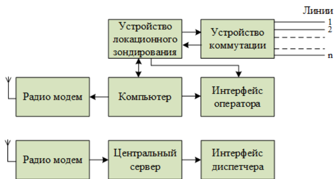
Рис. 3. Функциональная схема программно-аппаратного комплекса локационного мониторинга ЛЭП
