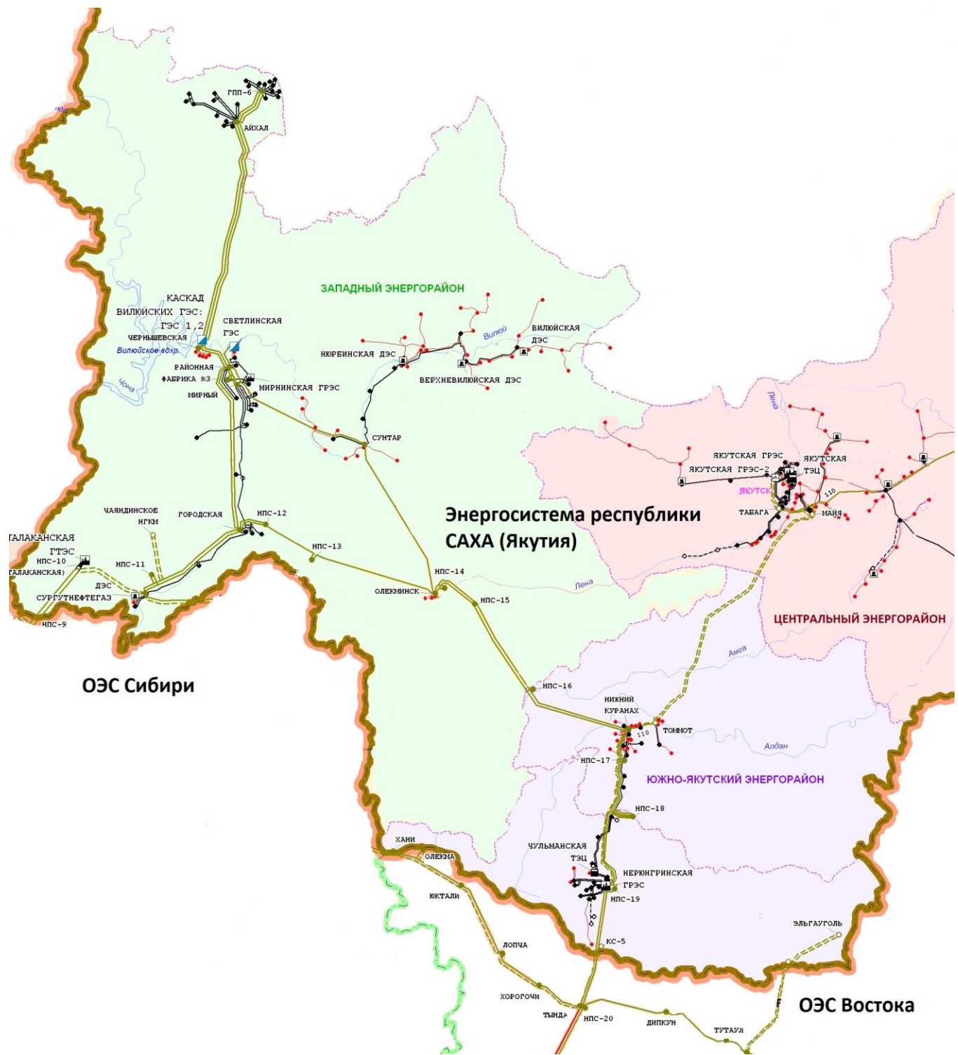
Схема основных электрических сетей 110 – 220 кВ энергосистемы Республики Саха (Якутия)
