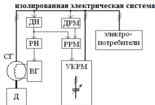
Рис. 1. Функциональная схема автономной электроэнергетической установки с компенсацией реактивной мощности: СГ – синхронный генератор; Д – двигатель; ВГ – возбуждатель генератора; УКРМ – установка компенсации реактивной мощности; РН – регулятор напряжения; РРМ – регулятор реактивной мощности; ДН – датчик напряжения; ДРМ – датчик реактивной мощности
