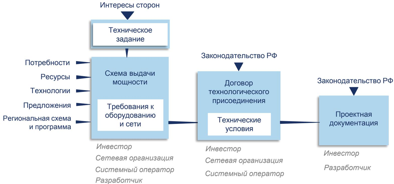
Схема выдачи мощности – способ определения оптимальных решений до выдачи технических условий, который реализуется:
