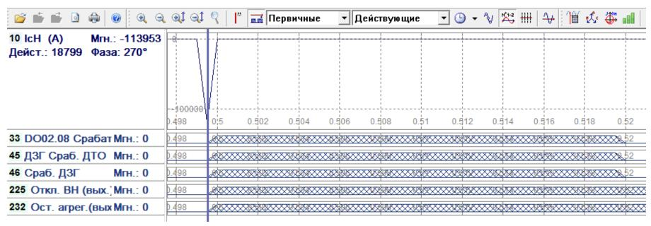
✓ Единичный отсчет, зафиксированный за 80 точек, приводит к срабатыванию функций РЗА, так как рассчитанное действующее значение на период превышает уставки срабатывания.
