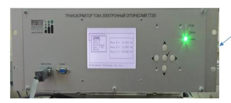
На данном этапе имеется наличие только местной сигнализации. Хоть имеется порт «Диагностика», но подключение к нему возможно только специализированными средствами. Необходима полноценная интеграция в АСУ ТП стандартными протоколами
