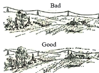
Рис.10. Предпочтительное положение опор ниже гребня хребта
