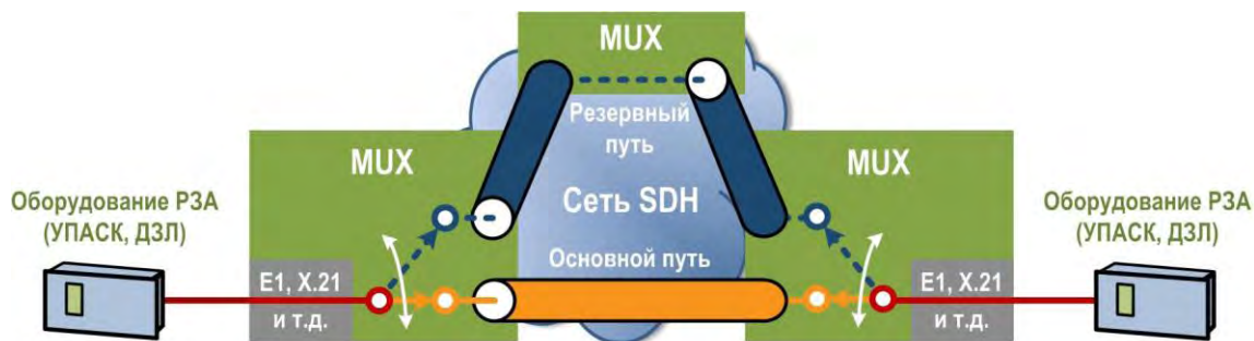
Рис. 2: Собственные механизмы резервирования сетей SDH/PDH
