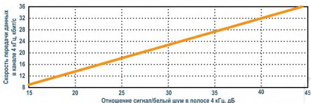
Рис. 5: Скорость передачи данных в ЦВЧ канале с полосой 4 кГц при вероятности ошибки 10^{-6}
