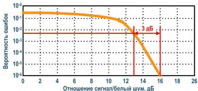
Рис. 7: Пример зависимости вероятности ошибок в ЦВЧ канале от ОСШ
