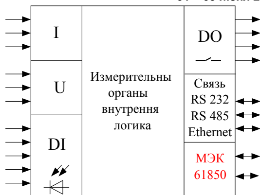
Рис.1 Классическая схема цифрового автомата, реализующего функции микропроцессорной РЗА
